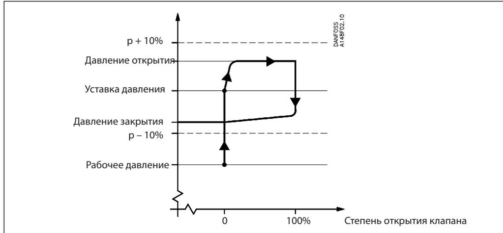
Клапаны BSV выпускаются как стандартные предохранительные клапаны (DIN 3320) для холодильных установок. При увеличении давления в системе выше давления настройки предохранительный клапан начинает открываться, сначала незначительно, чтобы обеспечить минимальный расход хладагента. Если давление в системе будет продолжать расти, клапан откроется полностью. Клапан полностью откроется до того, как
